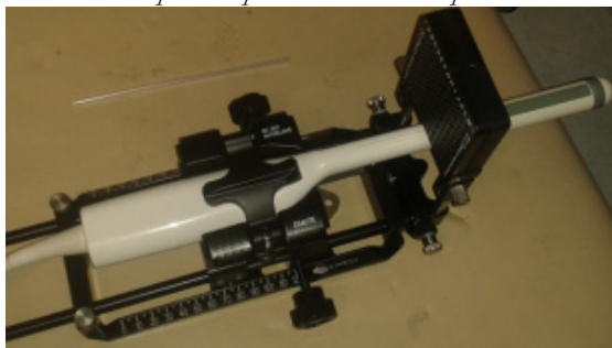
Fig. D-1: Motor paso a paso de CIVCO para la sonda TRT
